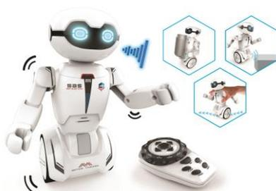
Nouveau robot humanoïde radiocommandé, MACROBOT de Silverlit est impressionnant : il tient seul sur son balancier, avance dans toutes les directions et tourne en détectant les obstacles. Ses bras bougent quand il se déplace. Il enregistre les voix et répète tout avec une voix de robot. Ses yeux LED changent de couleur. Il se contrôle par télécommande et ses mouvements sont programmables (technologie infrarouge).
