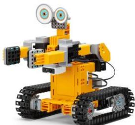
Le kit TANKBOT permet de se familiariser à la fois avec la construction et le codage robotique. Grâce aux six servomoteurs robotiques, le capteur infrarouge, les 190 pièces clipsables et l'application gratuite JimuRobot, l'utilisateur peut programmer et créer un robot intelligent, interactif et ludique, et faire partie de la communauté JimuRobot, en partageant ses créations.
